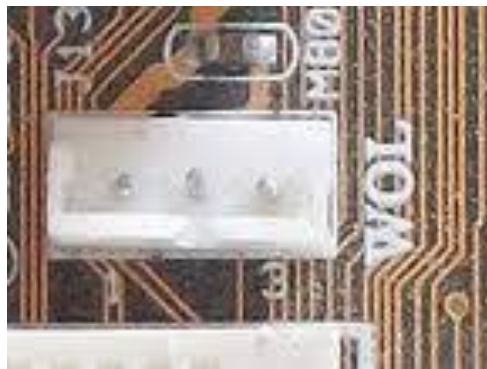
Conector WOL en placa base
