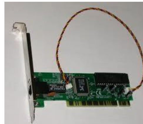
Conector WOL en tarjeta Red.
